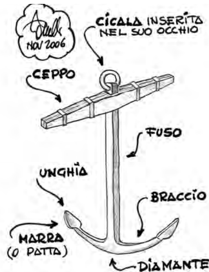
Schema dei componenti l'ancora ammiragliato con ceppo fisso in legno (dis. F. Rambelli).
