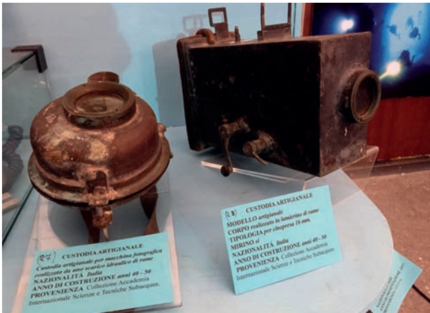
Due pezzi rari: custodie subacquee foto (a dx) realizzato da uno scarico idraulico in rame e cine (a sin) in lamierino di ferro saldato di costruzione artigianale anni '40-'50.
