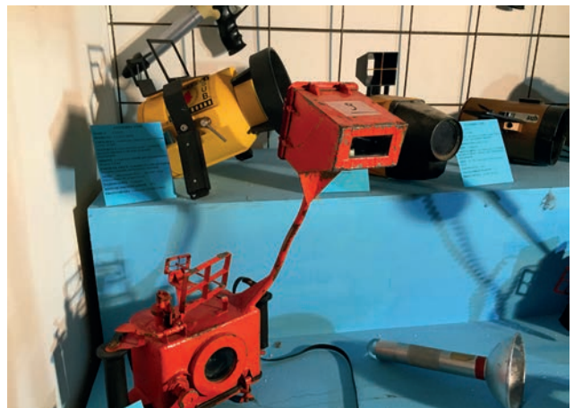
Custodia autocostruita in lamierino di rame per reflex 35 mm. e flash elettronico anni '70. In secondo piano varie custodie per cine S/8 Canon, Silma e Ima Sub anche queste anni '70.
